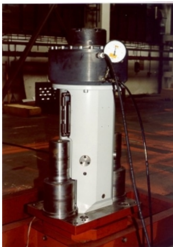
Obr. 5. Napínací jednotka na standu při zkoušce malocyklové únavy
