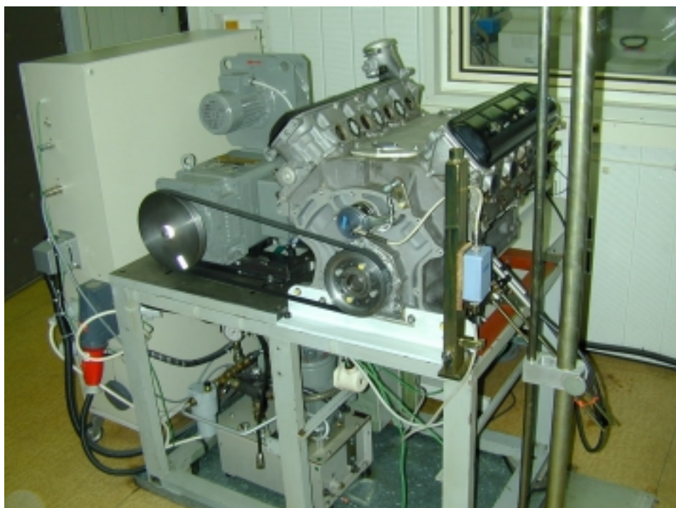
Obr. 2 Uspořádání experimentálního měření kinematiky ventilů
