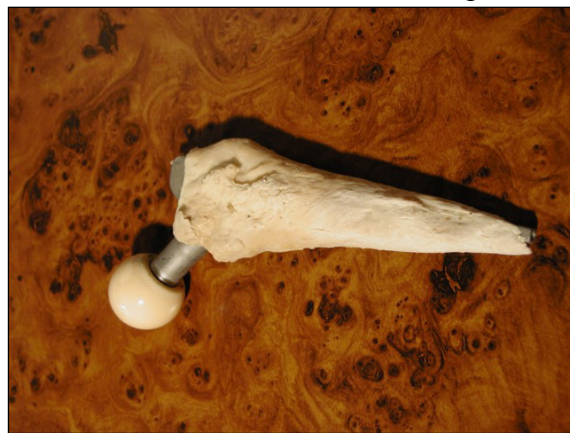
Obr. 1: Uvolněný dřík CF-30 – k aseptickému uvolnění došlo na rozhraní cement - femur
