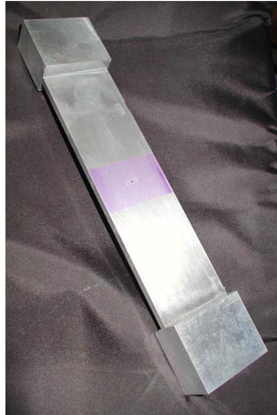
Obr. 5: Fotografie vzorku s centrální trhlinou, s nanesenou hexagonální mřížkou.
