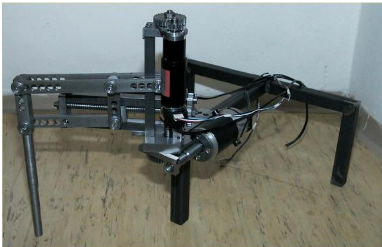
Obr. 1.: Fotografie nohy upevněné ke zkušebnímu přípravku.
