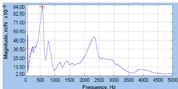
Obr. 4 Amplitudová charakteristika vřetena
