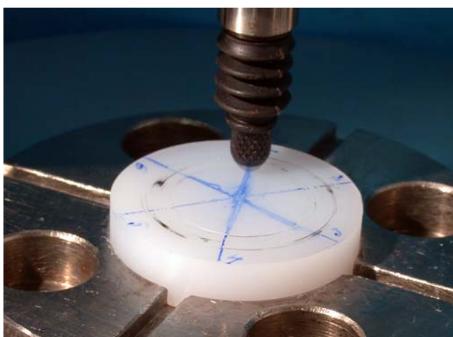
Obr. 6 Detail zaměření profilu disku úchylkoměrem MAHR EXTRAMESS 2001
