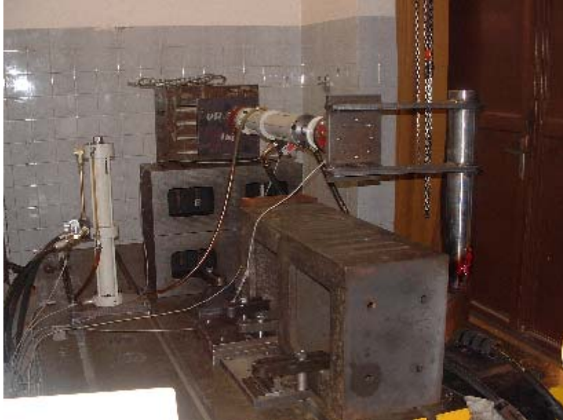
Obr.2 Celkový pohled na zatěžovaný konstrukční uzel
