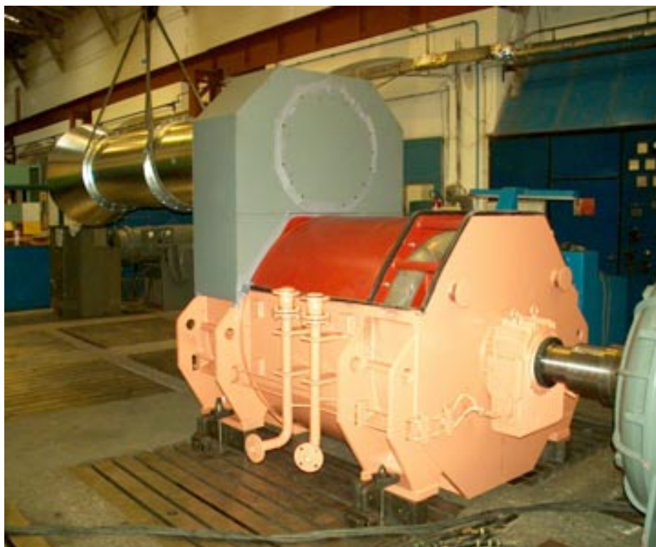
Obrázek 1 Příprava synchronního generátoru pro ventilační měření
