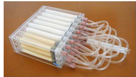
Obr. 2: Prvek 2 simulující systémový odpor krevního řečiště vyvinutý v Ústavu termomechaniky AVČR v Praze
