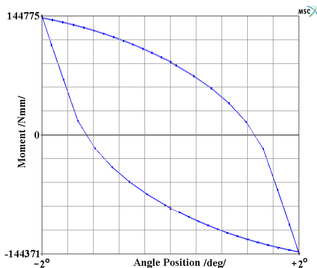
Obr.7 Závislost kroutícího momentu M_k /Nmm/ na úhlu natočení čepu (cyklus 5 a 6, čas t = 16 až 24 s).
