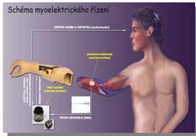
Obr. 7 Schéma myoelektrického řízení
