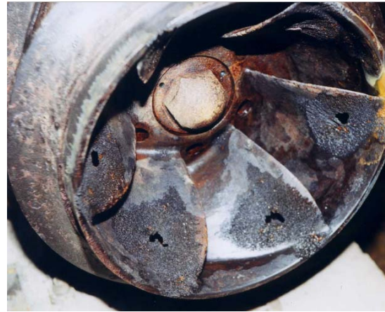
Obr. 1. Kavitační eroze lopatek oběžného kola zkoumaného vodního čerpadla SIGMA po dlouhém provozu.
