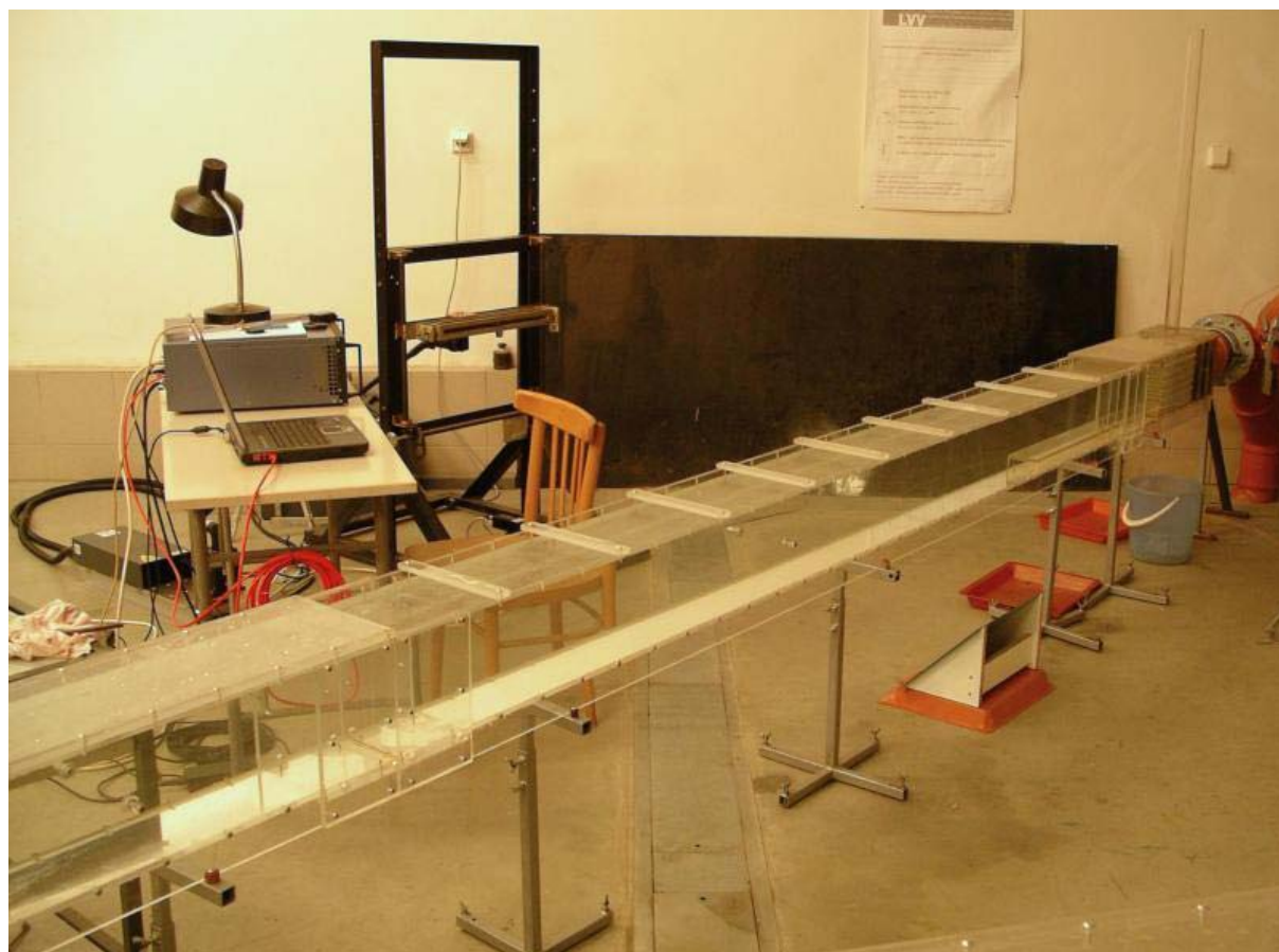
Obr.2 Celkový pohled na model při proudění s volnou hladinou
