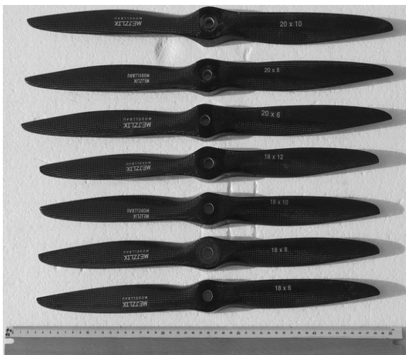
Obr. 2 Kompozitové karbonové vrtule typ Mejzlik o rozměrech 18"x 6-12", 20"x 6-10".
