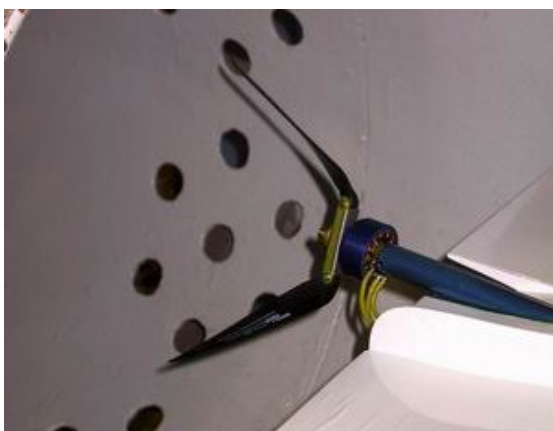
Obr. 6 Testovaná sklopná vrtule Aeronaut v aerodynamickém tunelu.
