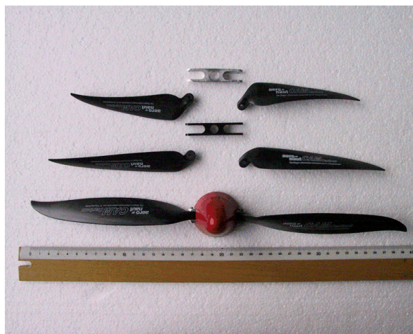
Obr. 3 Stavitelné vrtule Aeronaut o rozměrech 11"x10", 13"x11" a 15"x13" s unášeči.
