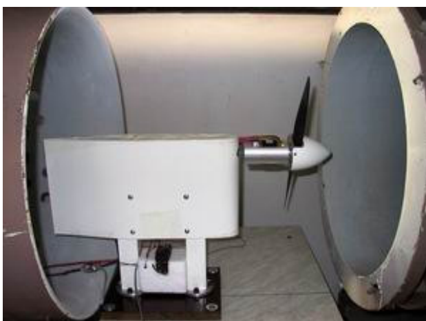
Obr. 4 Stend elektromotoru s vrtulí v měřicím prostoru aerodynamického tunelu.
