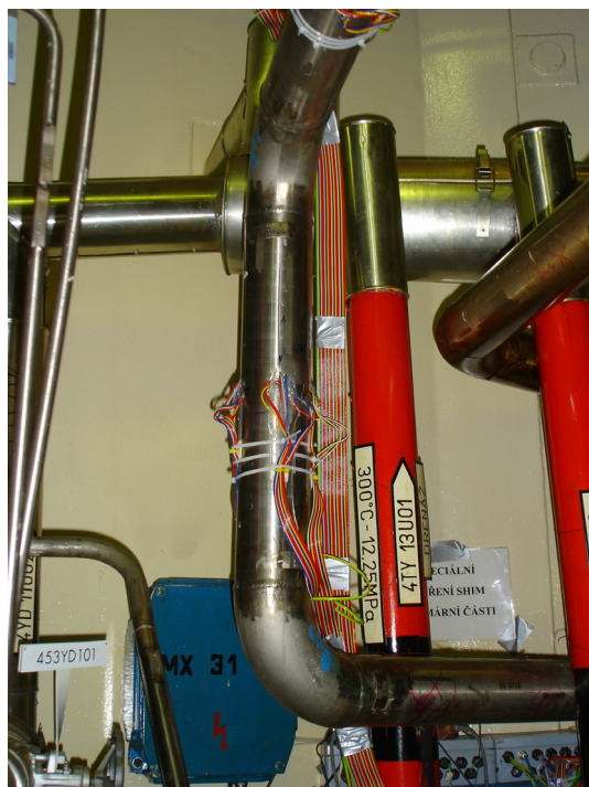
Obr.3. Tenzometry v řezu OUT2 s jedním termočlánkem. V horní části obrázku je částečně vidět řez OUT1. V pravé spodní části jsou umístěny obě měřicí jednotky MJ2 a MJ3 (modré kovové krabice s vývody)
