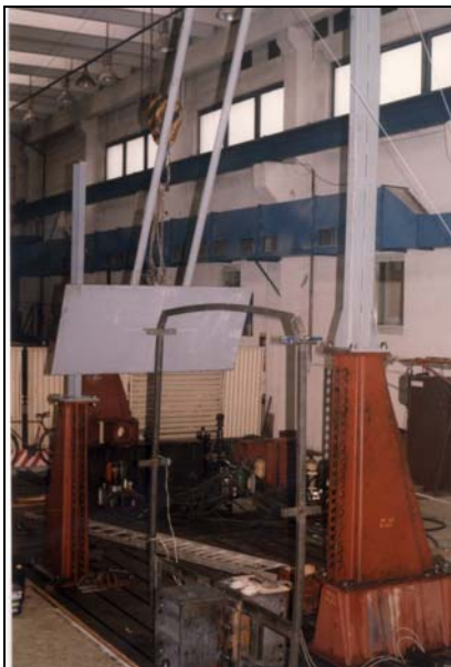
Obr. 11. Skúška úderu kyvadlom na časť karosérie
