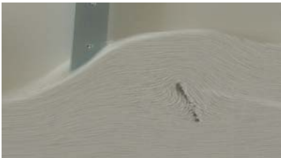
Obr. 6: Identifikace nelinearit v podobě proudnic a kluzných čar
