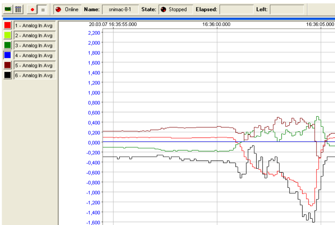
Obr. 5: Snímač při průniku materiálem ve směru šipky včetně vyhodnocení zatížení.
