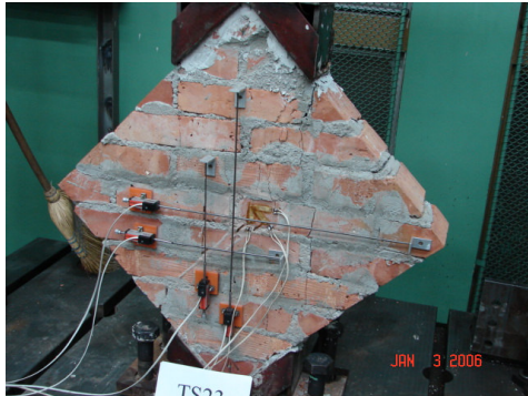
Obr. 3 Porušení experimentálního tělesa
