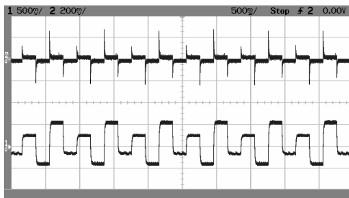
Obr. 30 Časový průběh kotevního proudu a napětí u_i – perioda dvě, kanál 2 – kotevní proud kanál 1 - napětí u_i
