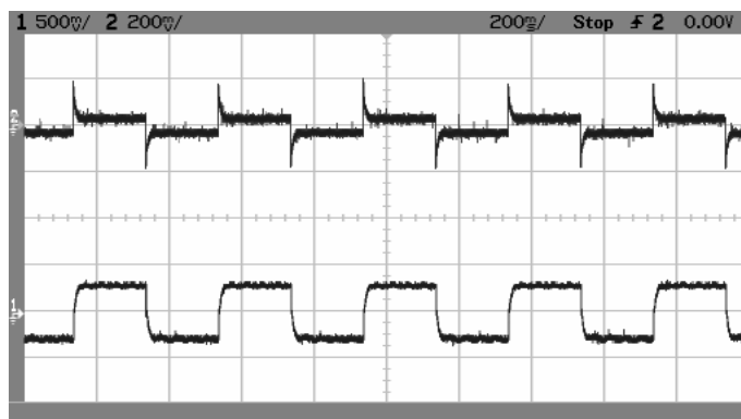
Obr. 28 Časový průběh kotevního proudu a napětí u_i – perioda jedna, kanál 2 – kotevní proud kanál 1 - napětí u_i
