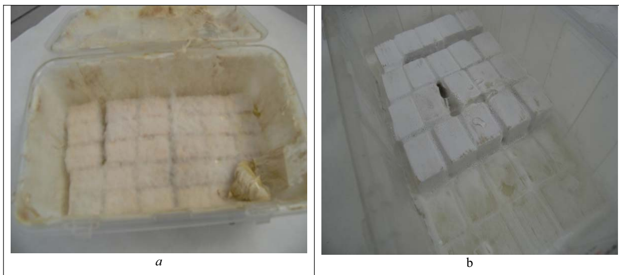
Obr.1 Zkušební vzorky uložené v kultivačním boxu s dřevokaznou houbou a) Serpula lacrymans (dřevomorka domácí); b) Trametes versicolor (outkovka pestrá), po 60 dnech od počátku kultivace.
