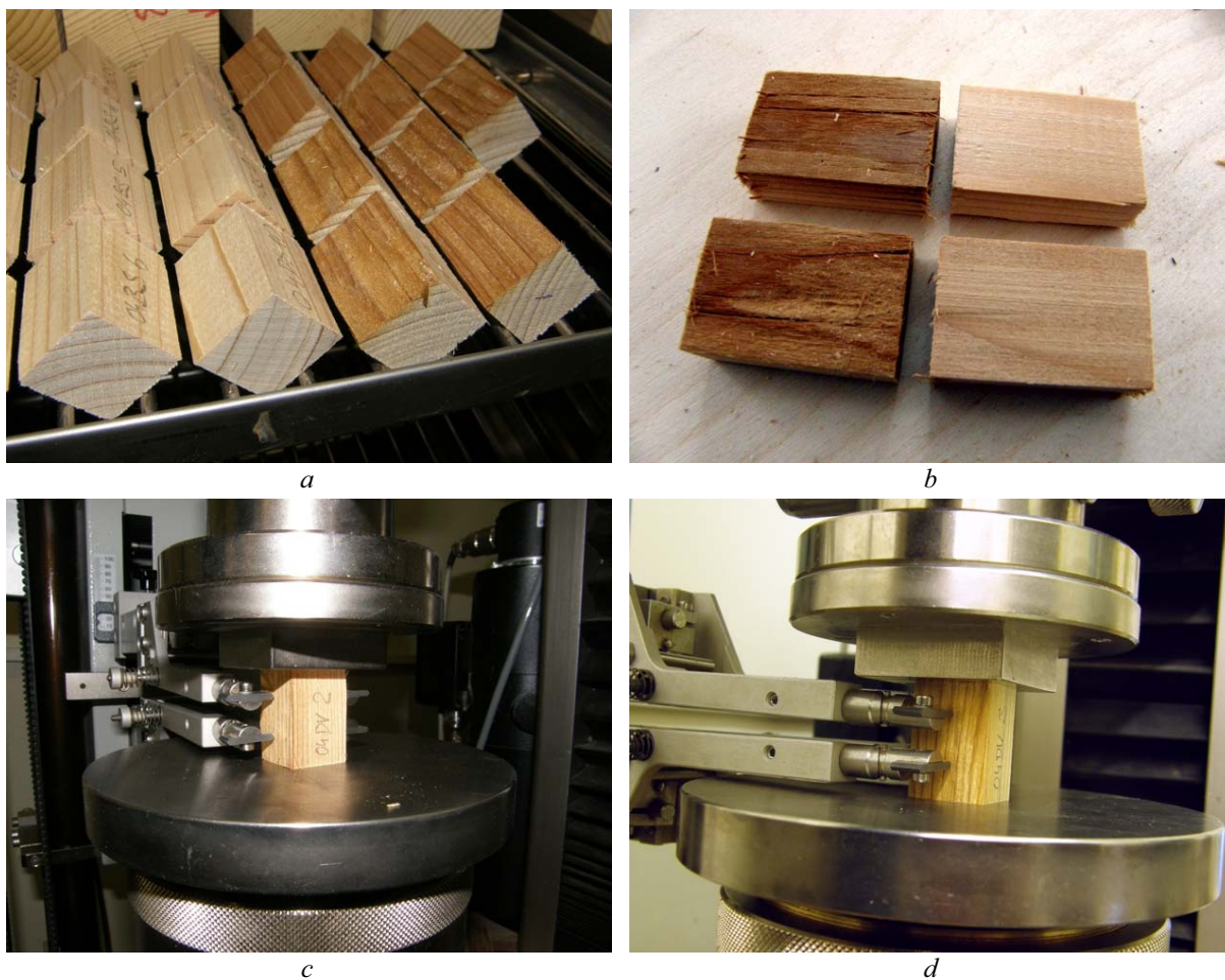
Obr. 4 Pevnost dřeva v tlaku podél vláken; standardní vzorky 20x20x30 mm (a); speciální tenčí vzorky 5x20x30 mm (b); průběh zkoušky (c, d).
