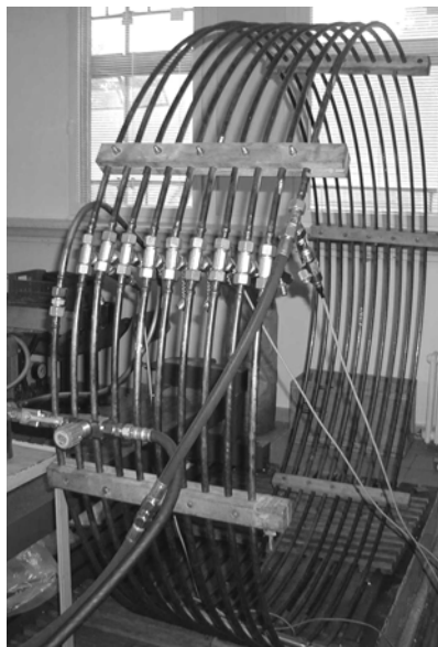
Obr. 11 Dlouhé potrubí v obvodu pro generování tlakových pulzů
