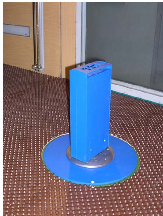
Obr. 2 a) Budova Shiran Tower. b) Model budovy ve větrném tunelu.
