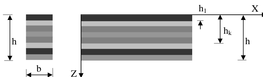
Obrázok 1 Geometria vrstevnatého prúta
